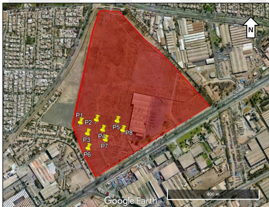
Figura 9. Distribución de pozos de prospección de 3,0 m de profundidad ejecutados en el interior del terreno en estudio (abril de 2025).
