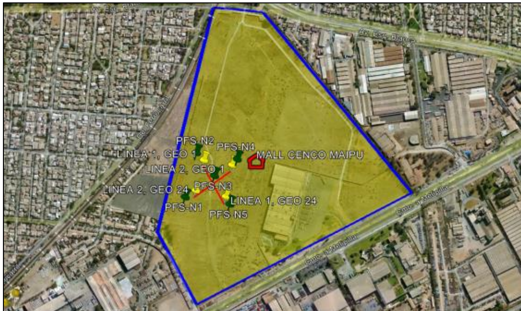
Figura 12. Disposición en terreno de las líneas sísmicas.
