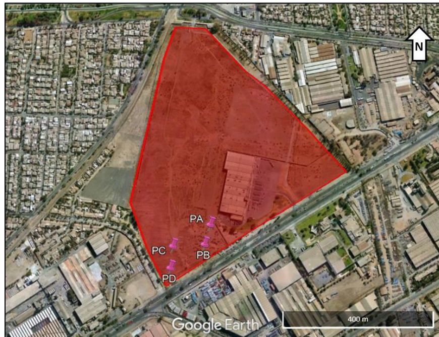
Figura 10. Distribución de pozos de prospección de 1,5 m de profundidad ejecutados en el interior del terreno en estudio (abril de 2025).
